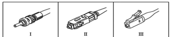
A figura mostra imagens (em escalas diferentes) de alguns conectores que são usados na montagem de cabeamentos de rede em fibra óptica. Assinale a alternativa que apresenta a sequência de nomes adequados para representar os conectores I, II e III, respectivamente.
