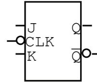
Suponha agora a conexão de todas as entradas “J” e “K” ao valor lógico 1, a saída “Q” do Flip Flop JK 1 à entrada CLK do Flip Flop JK 2, a saída “Q” do Flip Flop JK 2 à entrada CLK do Flip Flop JK 3. Tome as saídas “Q” dos três Flip Flops como as saídas do circuito. Aplique um sinal quadrado, de clock, à entrada CLK do Flip Flop JK 1. Considerando esses procedimentos, assinale a alternativa que apresenta o tipo de circuito que terá sido montado.
